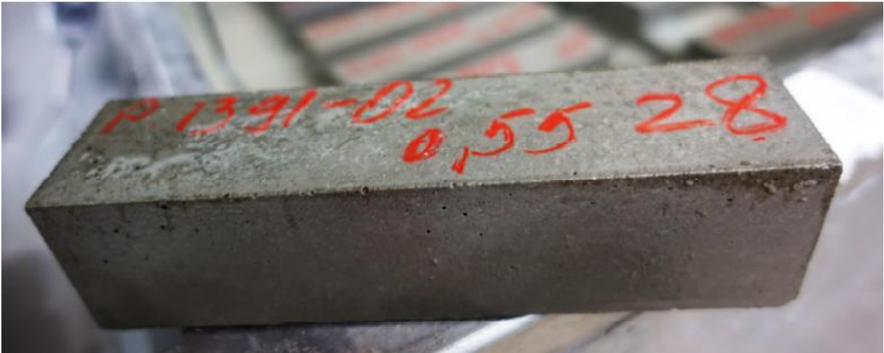
Bild zeigt Zement mit 30% qualitativ geeignete Bett-, Rostaschen. (Bild: Dr. sc. Nat. ETH, P. Kruspan Holcim (Schweiz) AG)
