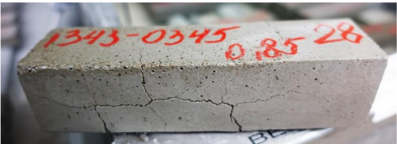
Bild zeigt Zement mit 30% qualitativ nicht geeignete Bett-, Rostaschen. (Bild: Dr. sc. Nat. ETH, P. Kruspan Holcim (Schweiz) AG)
