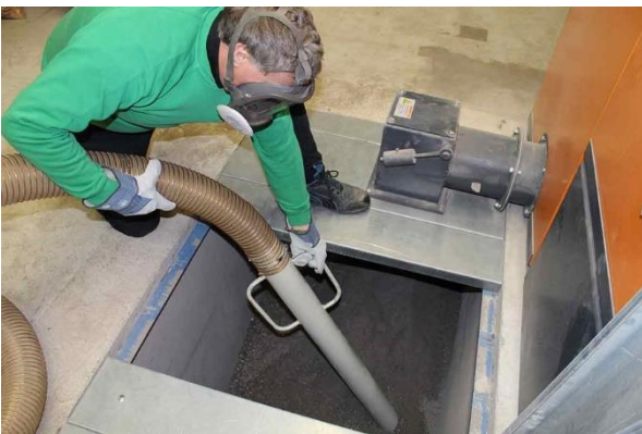
Abbildung 11: Bei allen Arbeiten im Kontakt mit Holzaschen wird empfohlen eine persönliche Staubschutzausrüstung zu tragen (Bild: Baumgartner AG)
