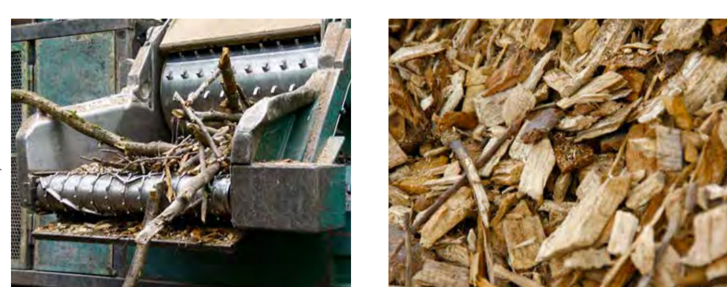
Das geerntete Holz wird zusammengetragen, gelagert und dann direkt vor Ort zu Hackschnitzeln verarbeitet.
